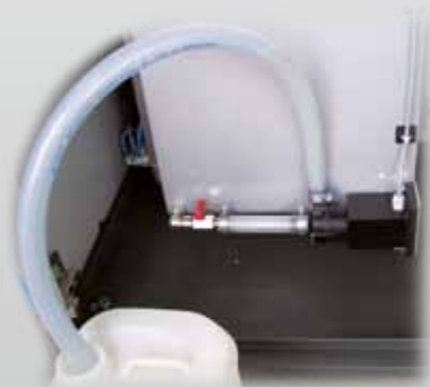
Eingebaute Tankentleerpumpe für verbrauchtes Kühlmedium. Zu entsorgen wie Kühlemulsion.
