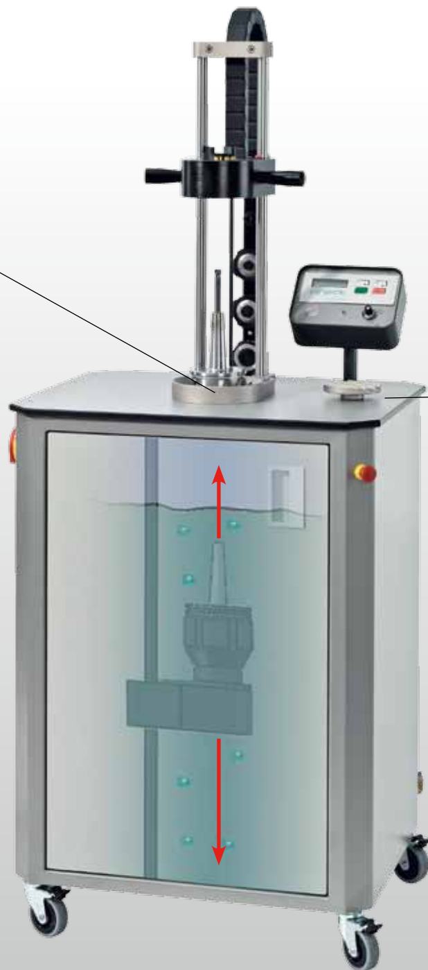
Pompa integrata di svuotamento del refrigerante usato dal serbatoio. Da smaltire come emulsione refrigerante.
