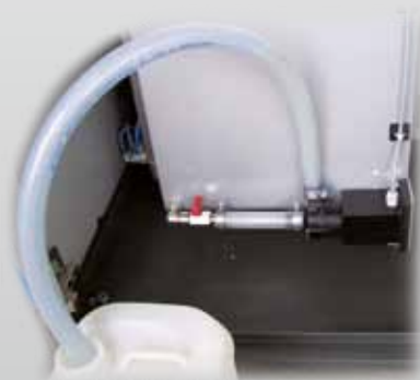
Pompe de vidange du réservoir intégrée, pour liquide de refroidissement usagé. A éliminer comme l'émulsion de refroidissement.
