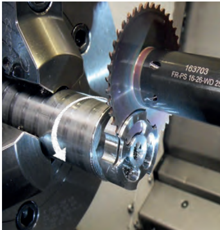
Abtrennen von VA-Formteilen Vc = 160 m/min Fz = 0,1 mm
