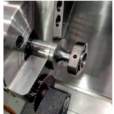
Abtrennen von Alu-Bauteilen Vc = 800 m/min Vorschub = 7000 mm/min
