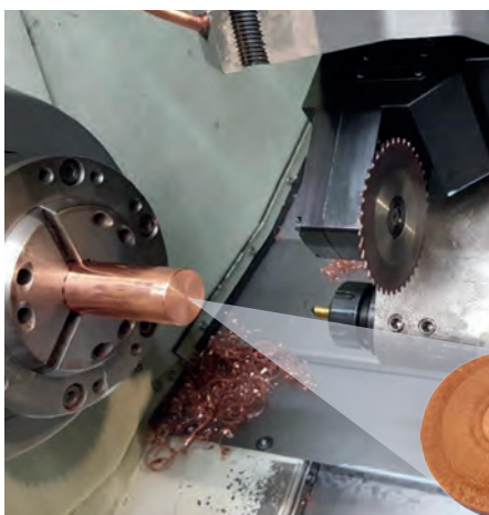
Abtrennen von CU-ETP – Formteilen Vc = 300 m/min Fz = 0,08 mm
